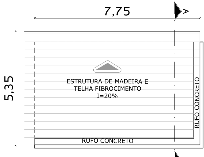
PLANTA DE COBERTURA CASA DE BOMBA ESC.: 1/50
