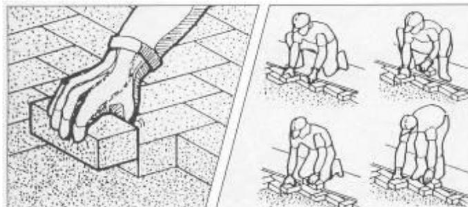
Como os blocos são colocados, principalmente, a mão, o colocador deverá usar, ao máximo, luvas de proteção. O seu trabalho, no nível do chão, é cansativo. Para evitar fadiga terá que mudar freqüentemente de posição.
