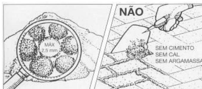
No rejunte deve ser utilizada areia fina com grãos menores do que 2,5 mm, do tipo utilizado para preparar rebocos de paredes. No instante da colocação, a areia deve estar bem seca e não conter cimento ou cal. Nunca utilizar argamassa, o que tornaria o rejunte muito quebradiço.
